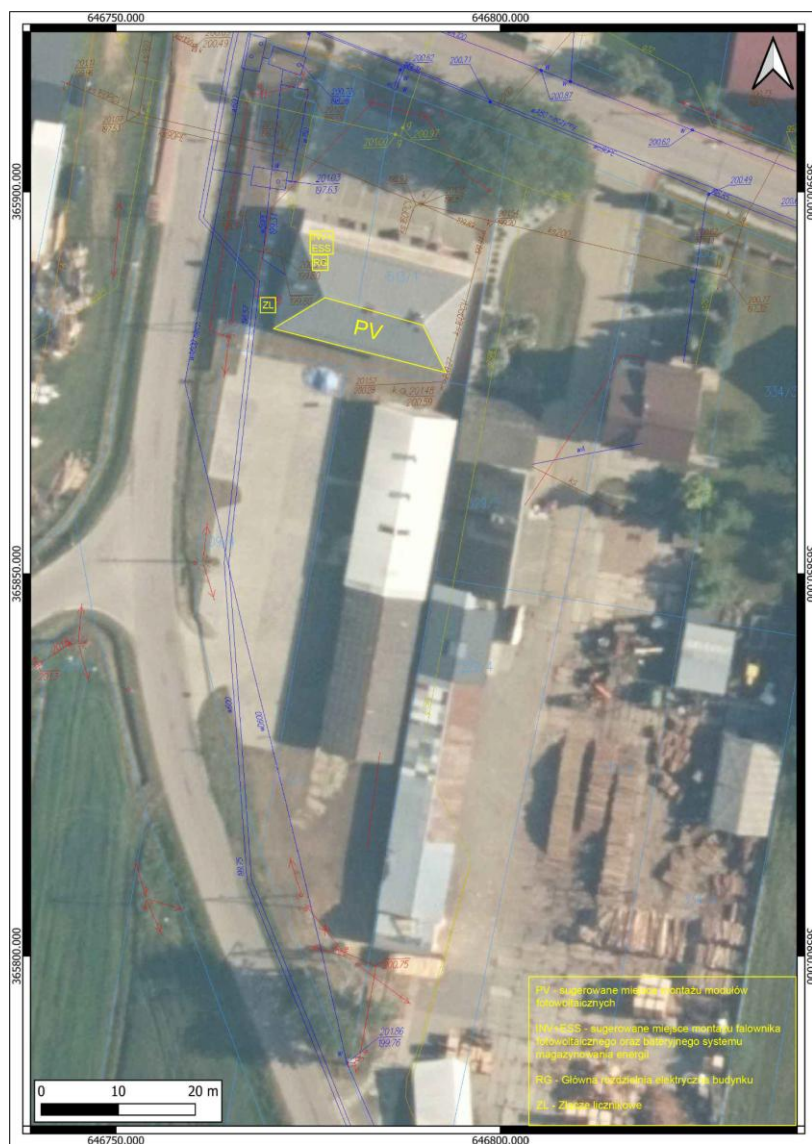
Rysunek 3.2 Lokalizacja złącza licznikowego i rozdzielnicy głównej oraz preferowana lokalizacja instalacji PV
